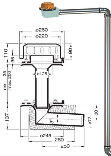
mit Wärmedämmung und Heizung
